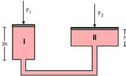
Admita que os cilindros estejam totalmente preenchidos por um líquido. O volume do cilindro II é igual a quatro vezes o volume do cilindro I, cuja altura é o triplo da altura do cilindro II. A razão entre as intensidades das forças  $F_2$  e  $F_1$ , quando o sistema está em equilíbrio, corresponde a:
