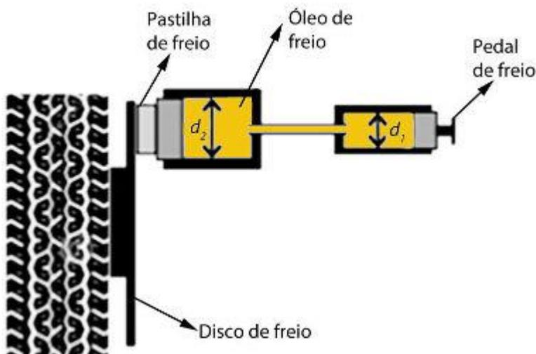
Considerando o diâmetro  $d_2$  do segundo pistão duas vezes maior que o diâmetro  $d_1$  do primeiro, qual a razão entre a força aplicada ao pedal de freio pelo pé do motorista e a força aplicada à pastilha de freio?
